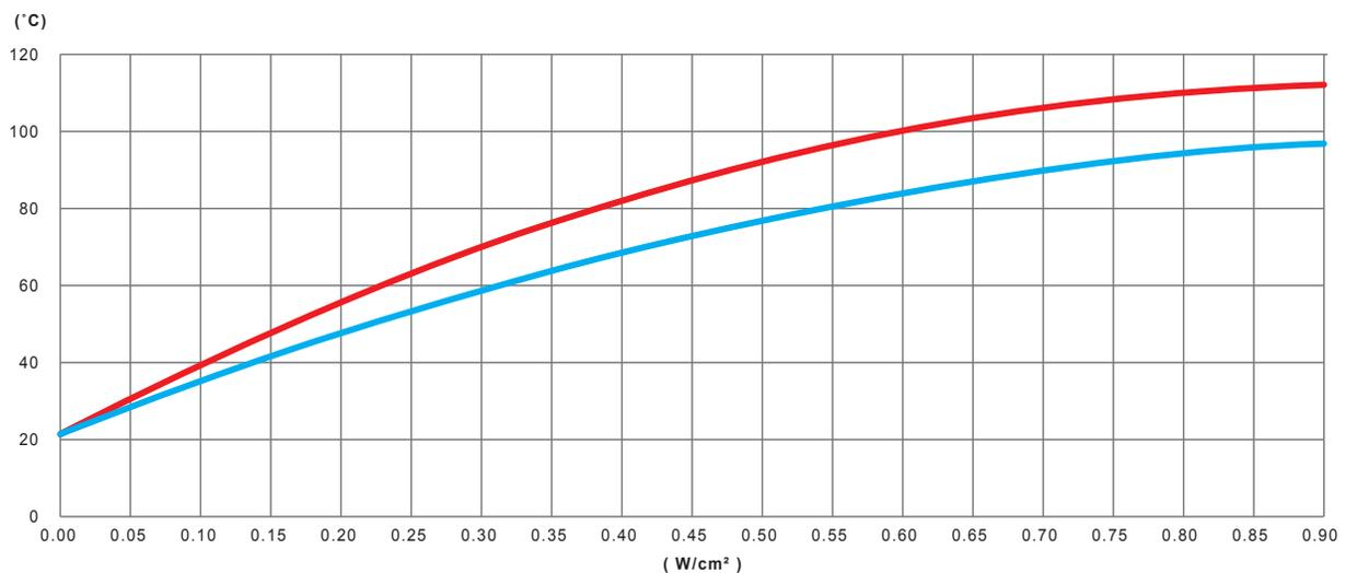
Variation, en fonction de la puissance en W/cm<sup>2</sup> du ruban chauffant en silicone, de la température de paroi d'un tube en acier inoxydable rempli d'eau non circulante, non isolé thermiquement
