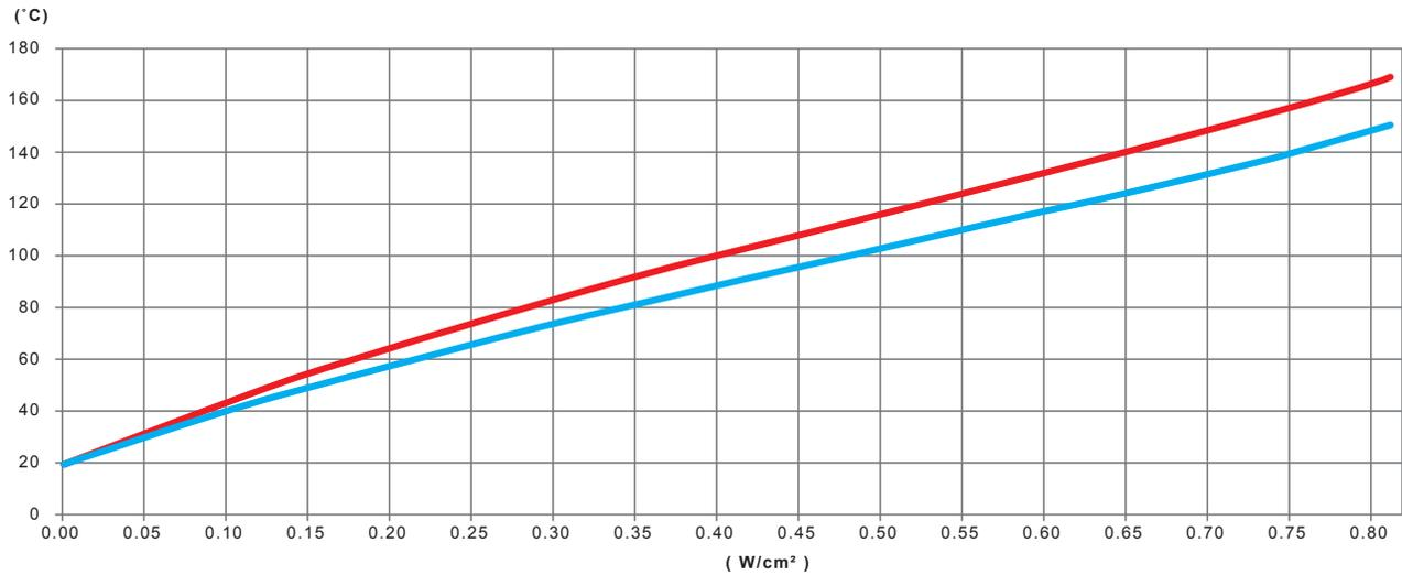
Variation, en fonction de la puissance en W/cm<sup>2</sup> du ruban chauffant en silicone, de la température de paroi d'un tube en acier inoxydable vide, non isolé thermiquement
