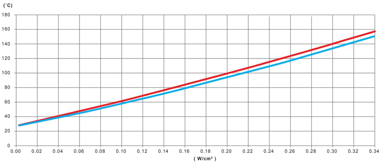
Variation, en fonction de la puissance en W/cm<sup>2</sup> du ruban chauffant en silicone, de la température de paroi d'un tube en acier inoxydable vide, isolé thermiquement par 20mm de mousse PVC-NBR
