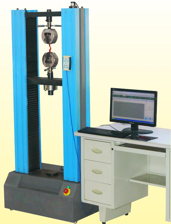
Equipement d'essai à la résistance au déchirement
