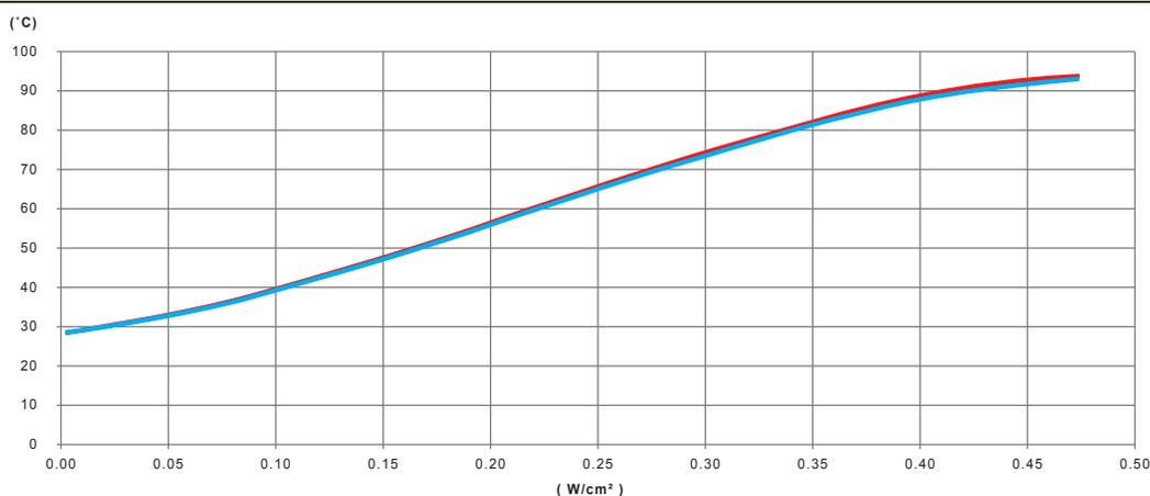
Variation, en fonction de la puissance en W/cm<sup>2</sup> du ruban chauffant en silicone, de la température de paroi d'un tube en acier galvanisé rempli d'eau non circulante, isolé thermiquement par 20mm de mousse PVC-NBR
