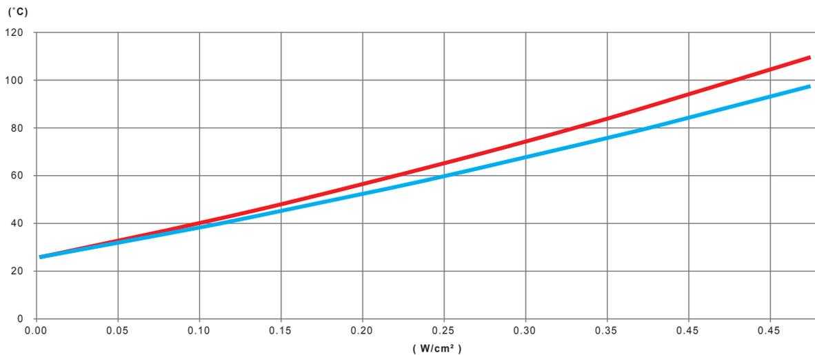
Variation, en fonction de la puissance en  $W/cm^2$  du ruban chauffant en silicone, de la température de paroi d'un tube en acier inoxydable rempli d'eau non circulante, isolé thermiquement par 20mm de mousse PVC-NBR
