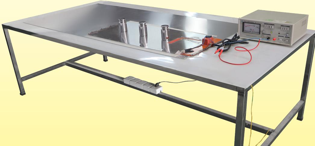
Dispositif de mesure de la résistance d'isolement.
