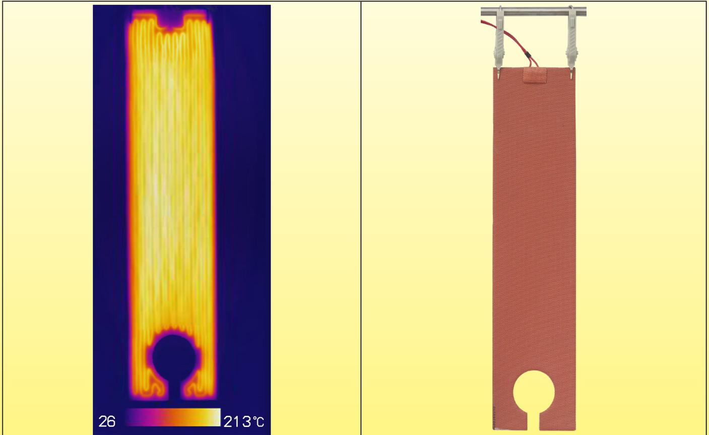
Image thermographique d'un résistance chauffante plate silicone épaisseur 2,4mm chargée à  $1W/cm^2$ , suspendue dans l'air calme, non fixée sur une paroi, à une température ambiante de  $25^{\circ}C$ . La température de surface atteint  $213^{\circ}C$ , soit une valeur proche de la destruction.
