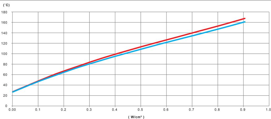
Variation, en fonction de la puissance en  $W/cm^2$  du ruban chauffant en silicone, de la température de paroi d'un tube en acier galvanisé vide, non isolé thermiquement
