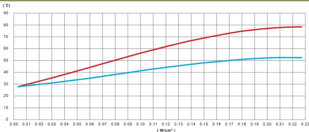
Variation, en fonction de la puissance en W/cm<sup>2</sup> du ruban chauffant en silicone, de la température de paroi d'un tube en PVC vide, non isolé thermiquement
