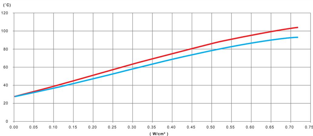
Variation, en fonction de la puissance en W/cm<sup>2</sup> du ruban chauffant en silicone, de la température de paroi d'un tube en acier galvanisé rempli d'eau non circulante, non isolé thermiquement
