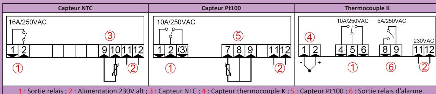
1 : Sortie relais ; 2 : Alimentation 230V alt ; 3 : Capteur NTC ; 4 : Capteur thermocouple K ; 5 : Capteur Pt100 ; 6 : Sortie relais d'alarme.
