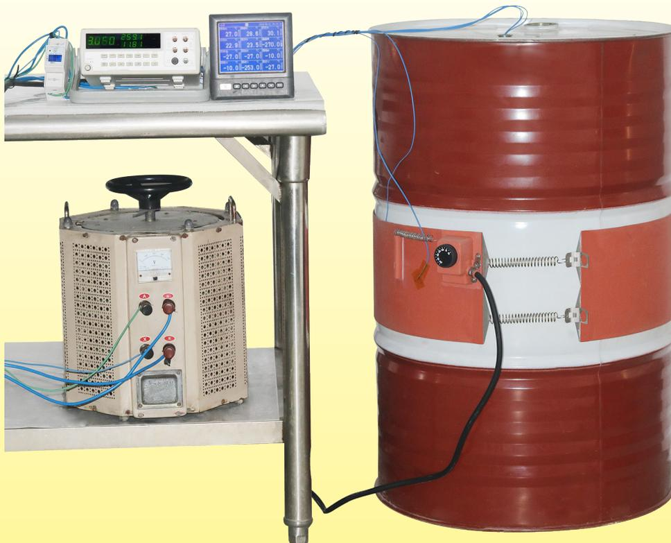
Variation de la température dans le temps de la température d'un fût métallique de 220 litres, rempli d'eau, réchauffé par une ceinture chauffante silicone de largeur 200mm, sans isolation thermique, de puissance 2250W (charge surfacique 0.75W/cm<sup>2</sup>).
